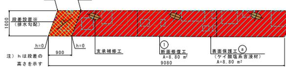
※ 縦目地と横目地接合部からの漏水が橋産面に滲水するのを防ぐため、橋産面に排水勾配を設置した。
